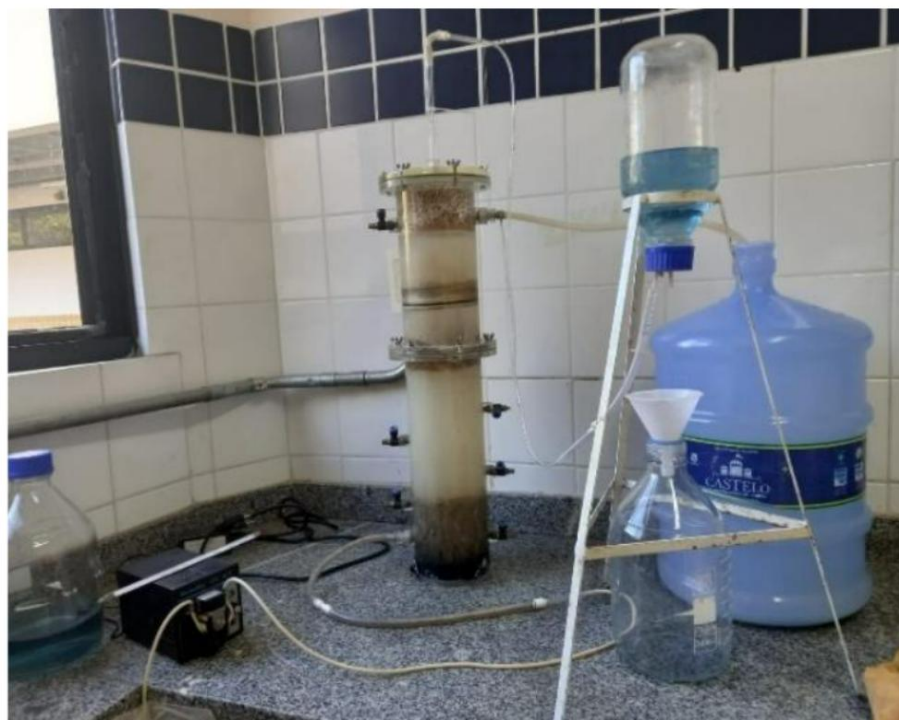
Figura 1 - Sistema de alimentação, reator UASB e coleta do efluente de soro de leite.
